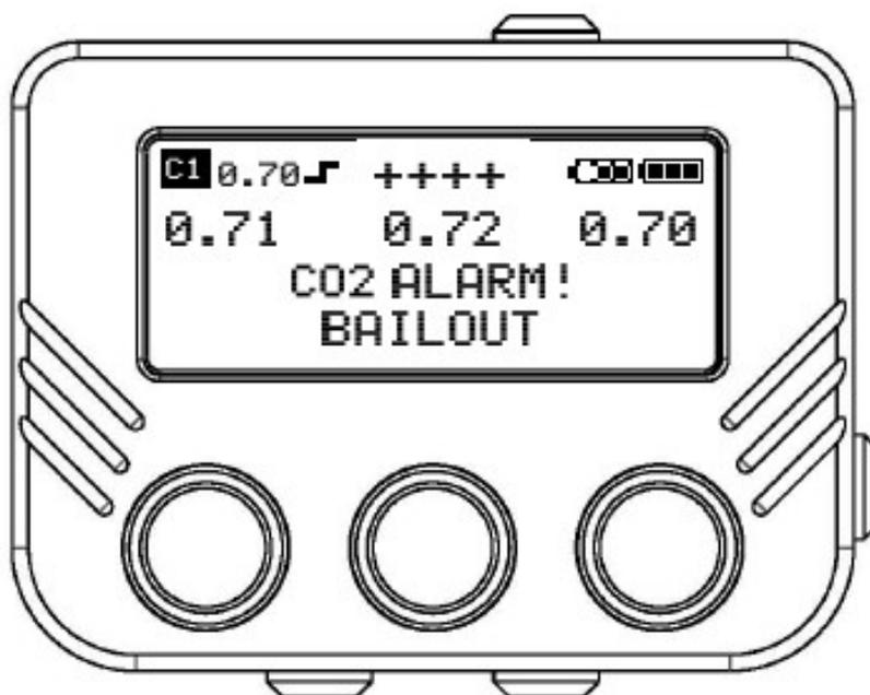
Le capteur CO2 déclenchera une alarme si la PPCO2 atteint 5 mbar dans la boucle respiratoire et l'afficheur indiquera « CO2 ALARM ! BAILOUT ». Cette alarme s'ajoutera à toute autre alarme déjà présente. Elle sera aussi indiquée sur le HUD et le buzzer sera activé. Le HUD affichera une lumière rouge fixe pour chaque contrôleur tant que la PPCO2 restera supérieure à 5 mbar..
